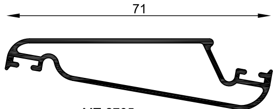
MT-2705 Tablilla celosía regulable Peso estimado: 0.529 Kg/m Largo STD: 6030 mm
