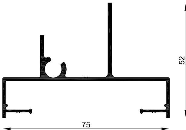
MT-0916 Marco ventana proyectante o banderola Peso estimado: 0.716 Kg/m Largo STD: 6150 mm
