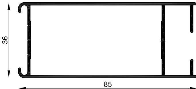
MT-0839 Parante puerta 36mm Peso estimado: 0.913 Kg/m Largo STD: 6150 mm
